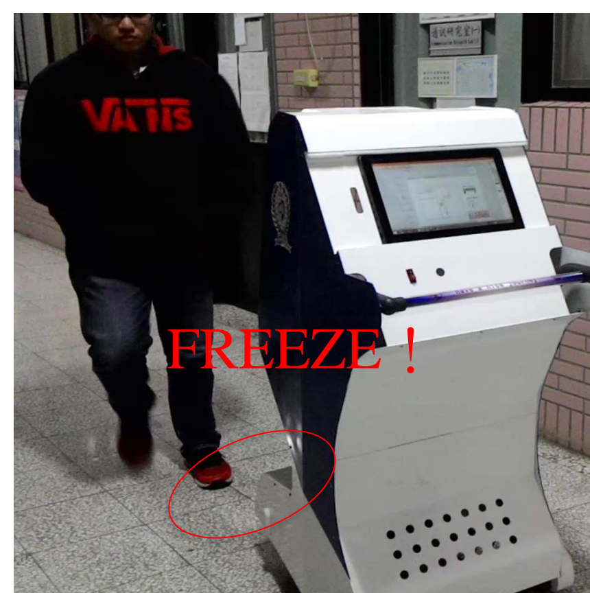
圖九、Laser Sensor偵測到障礙物
