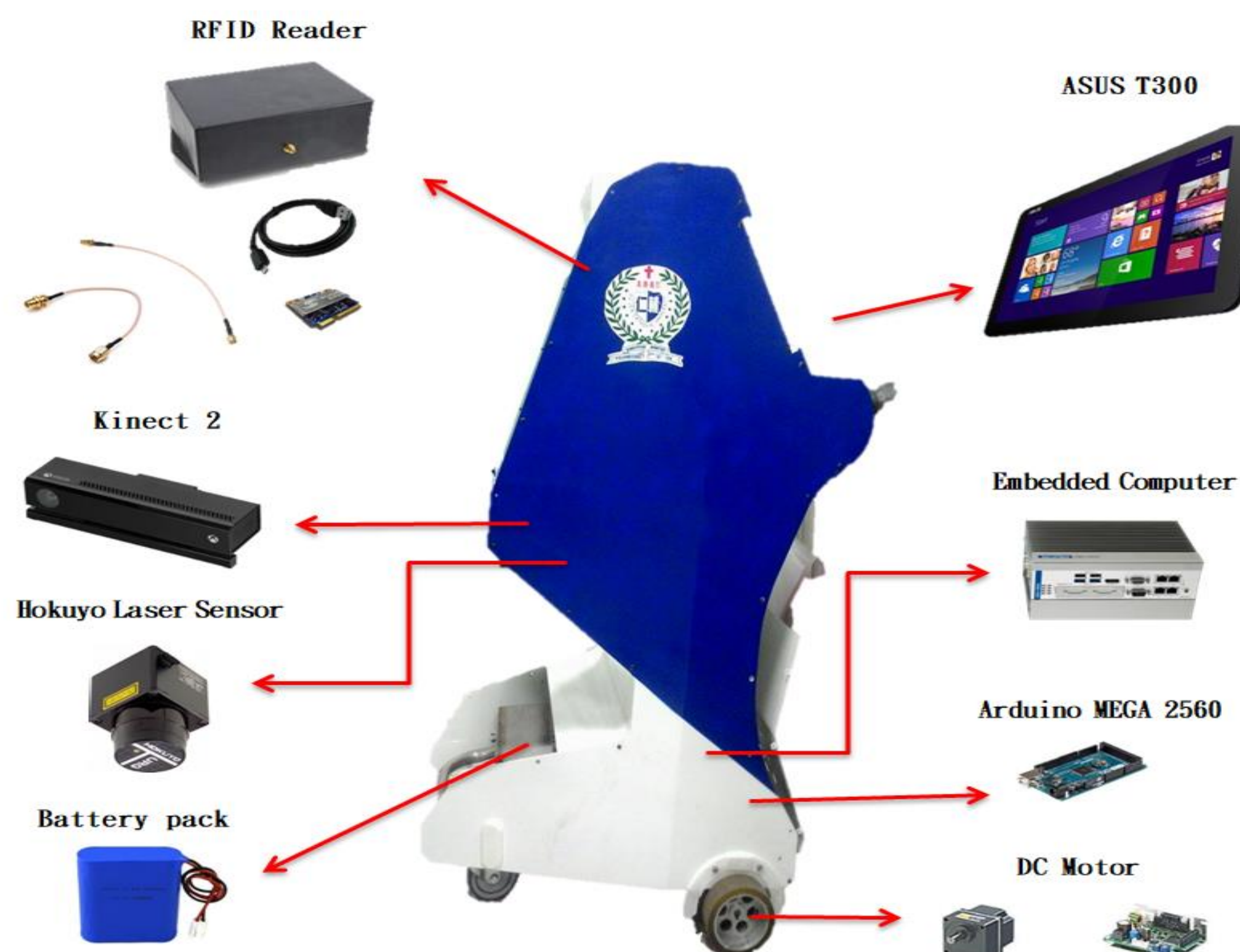
圖一、RFID自動結帳機器人硬體架構圖
